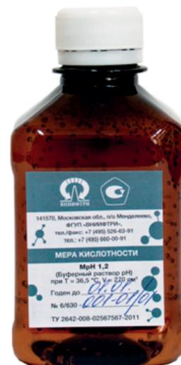
Мера кислотности представляет собой раствор соляной кислоты (HCl) и калия хлористого (KCl) в воде степени чистоты II, приготовленный в соответствии с документом «Приготовление меры кислотности МрН-1,2. Технологическая инструкция. МГФК.25101.00006».
