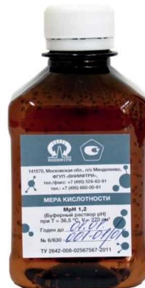
Рабочий эталон представляет собой раствор соляной кислоты (HCl) по ГОСТ 3118-77 и калия хлористого (KCl) степени чистоты о.с.ч. по ГОСТ 4234-77 в воде степени чистоты II по ГОСТ Р 52501-2005, приготовленный в соответствии с документом «Приготовление меры кислотности MrH-1,2. Технологическая инструкция. МГФК.25101.00006».
