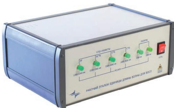
Рабочий эталон РЭД включает лазерные источники излучения и источник излучения с газонаполненными кюветами, обладающие нормированными спектральными линиями поглощения
