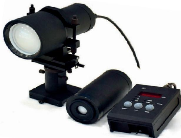
Лазерные джоульметры **ПРИМЕНЯЮТСЯ** при измерениях энергии в оборудовании, содержащем импульсные лазеры, например: в медицинских приборах и установках; в станках лазерной обработки материалов; в оборудовании для испарения тонких пленок; лазерных устройствах фотохимии и спектроскопии; в системах вооружения и военной техники и т.д.
